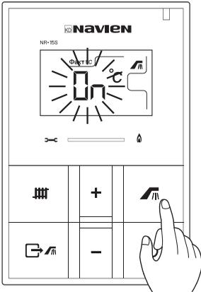
При выборе функции <Вне дома> на дисплее появится значок
