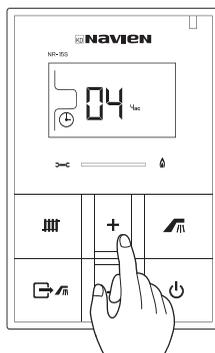
Когда мигает значок ☹️ нажмите кнопку + или - и выберите желаемое время повторной работы отопления в пределах 0~12 часов, информация сохраняется автоматически. За единицу времени принимается 1 час. Если установить время остановки на <04>, как изображено на рисунке, то отопления будет производиться в течении 4 часов по 30 мин.
