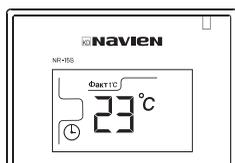
После установки обогрева по таймеру время на дисплее температуры исчезнет и вновь будет изображено настоящая температура. После наступления зафиксированного времени загорится индикатор горения и котел автоматически включится и начнет работать
